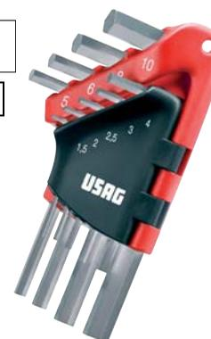
**N20 848** - Serie di chiavi maschio esagonali piegate UNI ISO 2936 DIN 911, in acciaio al cromo vanadio, esecuzione nichelata, **verniciatura con colore differenziato per ogni misura**, estremità piane e smussate.
