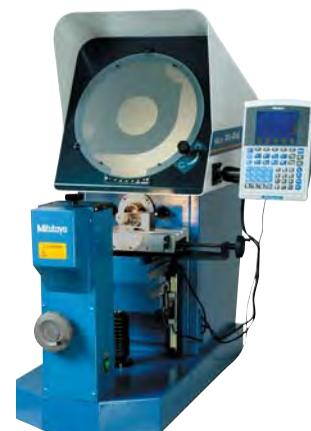
Proiettore di profili da banco con sistema ottico orizzontale adatto alla misurazione di pezzi grandi con peso fino a 45 Kg, immagine proiettata invertita. La tavola estremamente resistente, incorpora un sistema di misura con Linear scales X e Y risoluzione 0,001 mm (visualizzatore mod. KA oppure unità elaborazione dati opzionali), misura rapida degli angoli attraverso il goniometro analogico, fornito con obiettivo 10x (opzionali: 20x, 50x, 100x).
