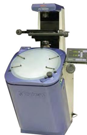
Proiettore di profili robusto a proiezione verticale, immagine proiettata invertita, funzione di inclinazione  $\pm 3^\circ$ . Sistema di misura Encoder Lineare con display digitale per assi X e Y risoluzione 0,001 mm, goniometro digitale per la misura di angoli con risoluzione di 2' di arco, fornito con obiettivo 10x (opzionali: 5x, 20x, 50x, 100x).
