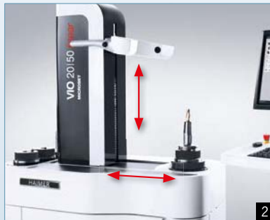
1: Funzione Release-by-Touch, semplice procedimento senza l'utilizzo di tasti 2 + 3: Asse ad induzione completamente automatizzata secondo la più moderna tecnologia lineare
