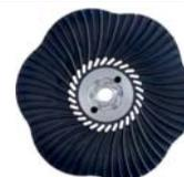
Platorello per l'uso dei dischi fibrati Combiclick® su smerigliatrici angolari. La geometria dei canali di raffreddamento permette un costante passaggio di aria che minimizza l'effetto di riscaldamento dell'utensile e del pezzo. Le ridotte temperature di contatto, l'ottimo sistema di bloccaggio e la stabilità del platorello permettono di aumentare la capacità di asportazione fino al 25% in più.
