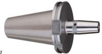
Mandrino a calettamento termico ISO 50 DIN ISO 7388-1 (ex DIN 69871) **forma ADB**, per il serraggio di utensili in HSS e Metallo Duro con **codolo cilindrico in tolleranza h6**; possibilità di regolare la sporgenza dell'utensile mediante vite integrata al mandrino. Disponibile in versione corta, ZG e extralunga.
