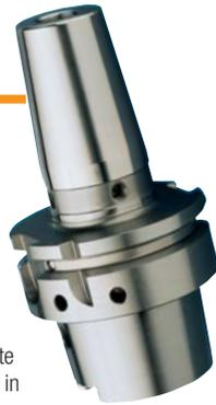
Mandrino a calettamento termico HSK-A 63 DIN 69893, costruito in acciaio per la lavorazione a caldo resistente alle alte temperature temprato 54-2 Hrc, per il calettamento di utensili in HSS e Metallo Duro con **codolo cilindrico in tolleranza h6**; possibilità di regolare la sporgenza dell'utensile mediante vite integrata al mandrino. Disponibile in versione corta, ZG e extralunga. Fornito con **bilanciatura standard G 2.5 25000 giri/min o U<1gmm**.
