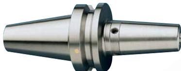
Mandrino a calettamento termico JIS B 6339 MAS BT 50 **forma ADB**, per il serraggio di utensili in HSS e Metallo Duro con **codolo cilindrico in tolleranza h6**; possibilità di regolare la sporgenza dell'utensile mediante vite integrata al mandrino. Disponibile in versione corta, ZG e extralunga. Fornito con **bilanciatura standard G 2.5 25000 giri/min.**
