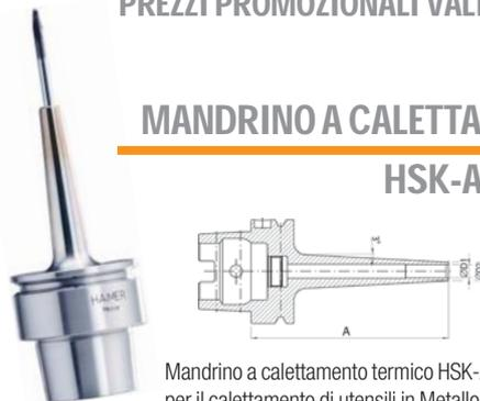
Mandrino a calettamento termico HSK-A 63 DIN 69893-1, Mini Shrink, per il calettamento di utensili in Metallo Duro con **codolo cilindrico in tolleranza h6**. Disponibile in versione ZG e lunga. Fornito con **bilanciatura standard G 2.5 25000 giri/min o U<1gmm**.
