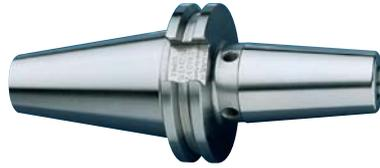
Mandrino a calettamento termico ISO 50 DIN 69871 **forma ADB**, per il serraggio di utensili in HSS e Metallo Duro con **codolo cilindrico in tolleranza h6**; possibilità di regolare la sporgenza dell'utensile mediante vite integrata al mandrino. Disponibile in versione corta, ZG e extralunga. Fornito con **bilanciatura standard G 2.5 25000 giri/min.**
