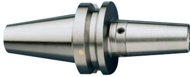
Mandrino a calettamento termico JIS B 6339 MAS BT 40 **forma ADB**, per il serraggio di utensili in HSS e Metallo Duro con **codolo cilindrico in tolleranza h6**; possibilità di regolare la sporgenza dell'utensile mediante vite integrata al mandrino. Disponibile in versione corta, ZG e extralunga. Fornito con **bilanciatura standard G 2.5 25000 giri/min o U<1gmm**.
