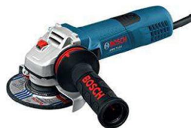
Smerigliatrice angolare per mole da 115 mm di diametro, testata ingranaggi ribassata per lavorare nei luoghi stretti, raffreddamento diretto per un'elevata resistenza al sovraccarico e una lunga durata, interruttore di sicurezza per l'accensione controllata dell'utensile e per un'elevata sicurezza dell'utilizzatore, cuffia di protezione antirotazione per garantire la massima sicurezza anche in caso di rottura della mola.
