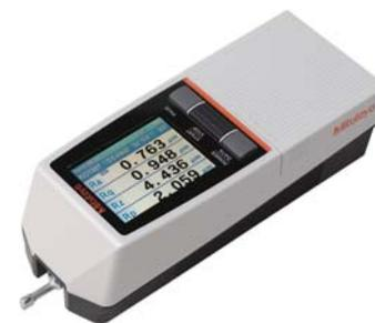
Rugosimetro portatile per misure di rugosità con sistema a pattino, LCD grafico 6 cm, a colori retroilluminato, batteria ricaricabile per misurazioni sul posto, comodi tasti sulla parte frontale dello strumento e sotto l'apposita cover, possono essere memorizzate fino a 10 condizioni di misura ed un profilo di misura, una memory card (opzionale) può essere utilizzata per estendere le capacità di memoria.
